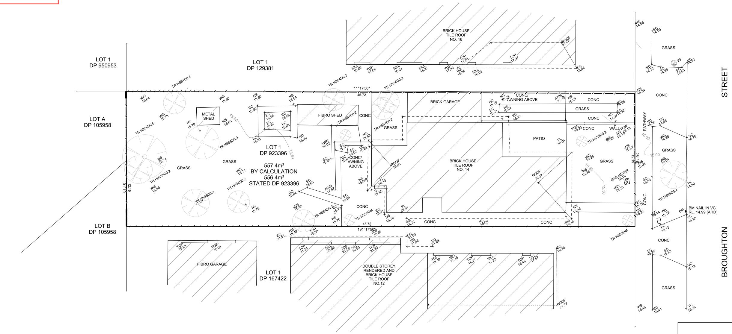
LEGEND: ADJOINING BUILDING AHD AUSTRALIAN HEIGHT DATUM BM**BENCH MARK** BEAM BOTTOM LEVEL **BEAM TOP LEVEL** TELSTRA PIT TEL CONC CONCRETE CS CONCRETE SURFACE EC EDGE OF CONCRETE D/H/S DIAMETER/HEIGHT/SPREAD DOOR E-G EAVE & GUTTER FLOOR LEVEL **POWER POLE** GDN GARDEN NATURAL SURFACE **POWER POLE** REDUCED LEVEL STEPS STOP VALE SILL WINDOW SILL TOP OF KERB TOP TOP OF WINDOW SV STOP VALVE VC VEHICLE CROSSING
